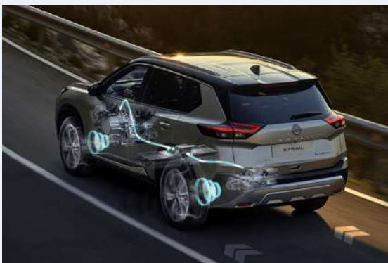
Tanto en el Ariya como en el X-Trail las ruedas son accionadas puramente por motores eléctricos alimentados por la batería.
