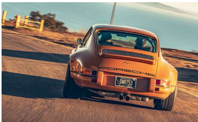
← La trasera del Classic Study fascina por su anchura, y se distingue por el alerón retráctil que estrenó el 911 tipo 964. La carrocería es de fibra de carbono y el sonido del escape central es glorioso.
